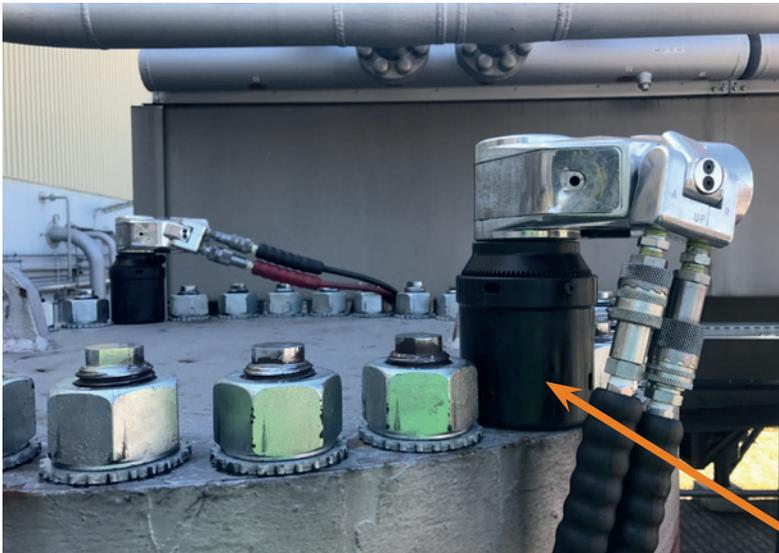
Le module d'entraînement est utilisé avec les rondelles de serrage "Z". Ce module est compatible avec différents outils de serrage : clés dynamométriques hydrauliques ou visseuses dynamométriques électriques ou pneumatiques.
